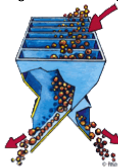
Figuur 32: Statische spleetverdeler
