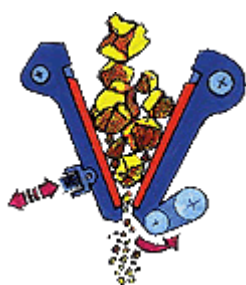
Figuur 6: Kaakbreker (jaw crusher)
