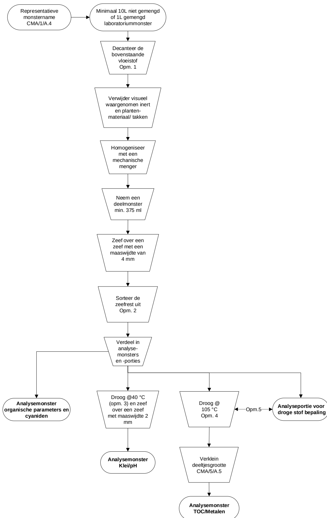
Figuur 1: flowchart monstervoorbehandeling Waterbodem voor gebruik als bodem
