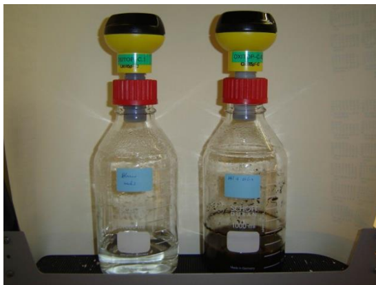
Figuur 1: Foto van een gesloten respirometer met drukmeetkop en adapter
