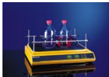
Figuur 21: Schudtafel met heen- en weergaande beweging
