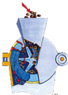
Figuur 23: Slagrotormolen (Rotor beater mill)
