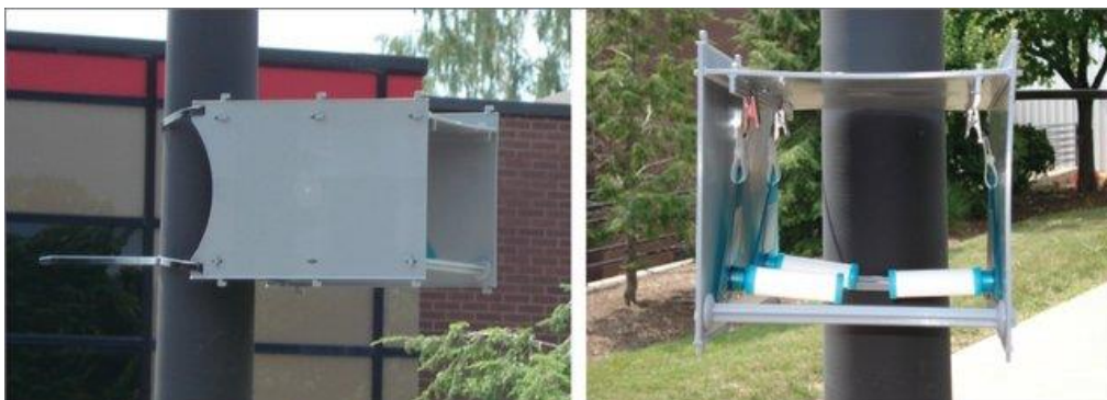
Figuur 9: Afscherming van passieve samplers bij de uitvoering van buitenluchtmetingen
