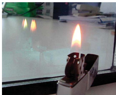
Figuur 123: Vaststellen van de aanwezigheid van een coating in een beglazing: beglazing met coating
