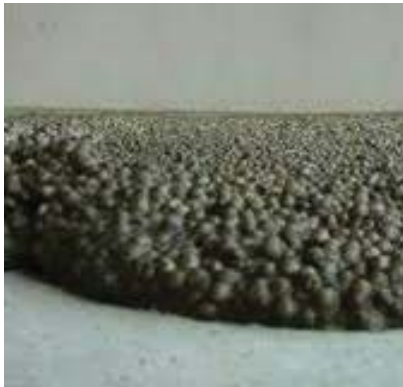
Isolerende mortel met EPS- parels
