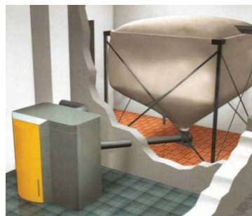
Pelletopslag in een afzonderlijke ruimte met automatische schroefaandoer
