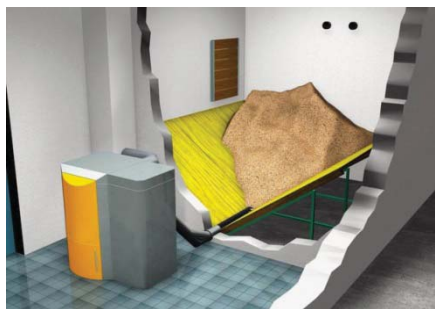
Pelletopslag in een silo met aanzuigsysteem
