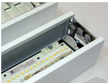
Figuur 82: Niet-vervangbare LED-chips in een verlichtingsarmatuur
