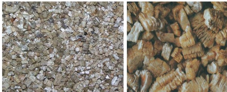
Figuur 112: Vermiculiet: platen (links) en korrels (rechts)
