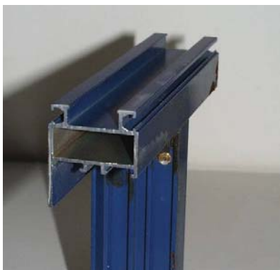
Figuur 125: Profiel zonder thermische onderbreking
