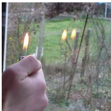
Figuur 121: Dubbele beglazing
